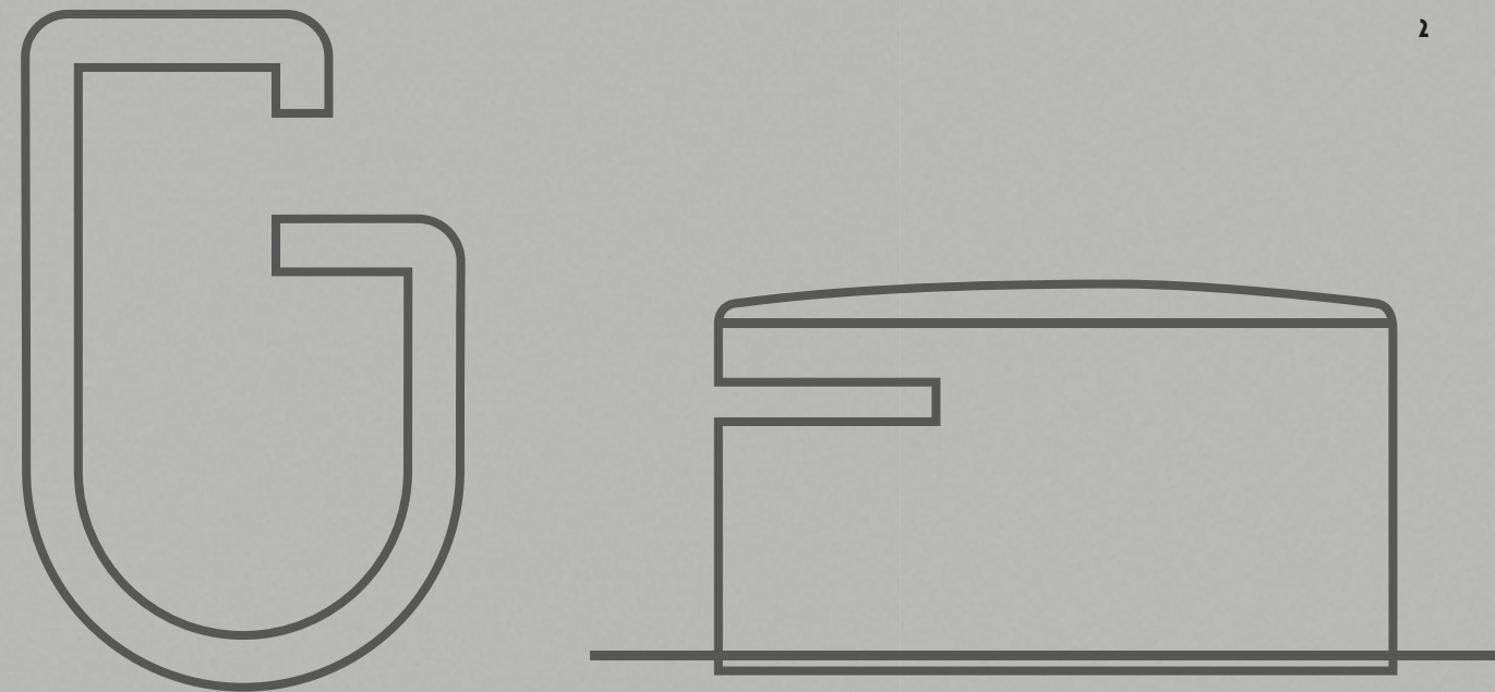
Planta i alçat d'un niu de metralladora.
